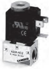
2/2 и 3/2 лин./поз. распределители, для индивидуального монтажа, могут быть нормально закрытыми и нормально открытыми. Присоединение может быть G1/8 или M5. Для нормально открытых клапанов АХХ2-... подвод воздуха осуществляется через отверстие пилотной части над соленоидом (M5). Для А333-...подвод воздуха осуществляется через присоединительное отверстие в корпусе.
