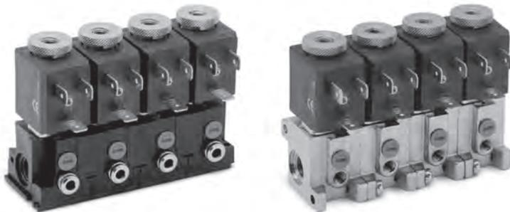
Электропневматические распределители прямого действия Серии А могут работать на воздухе как с распыленным маслом, так и без масла. Они поставляются 2/2 и 3/2 лин./поз. нормально закрытые (Н.З.) или нормально открытые (Н.О.). Также они могут иметь различное исполнение корпуса - с резьбовыми отверстиями для подключения трубопроводов и приточного исполнения - для наиболее полного охвата всех случаев применения.
