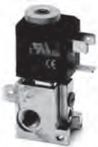
3/2 лин./поз. распределители для группового монтажа поставляются Н.З. (нормально закрытыми), с присоединением G1/8 для магистрального давления, выходом может быть коннектор M5 или быстроразъемное соединение Ø4. Эти клапаны снабжены ручным дублированием с защитой от случайного включения и могут быть моностабильными и бистабильными. Поставляются с круглым уплотнительным кольцом и винтами.
