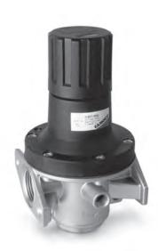
Регуляторы давления Серии С поставляются с присоединением G1 и имеют резьбовое отверстие для установки манометра. Регуляторы давления Серии С не предназначены для панельного монтажа.
